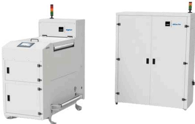
Avec **WEKO-SiliCon** ou **WEKO-SiliCon Pro**, vous disposez de la solution idéale pour protéger votre surface fraîchement imprimée avec une petite quantité d'une ou deux émulsions de silicone tout en la réhumidifiant. Les deux systèmes sont faciles à adapter ultérieurement.
