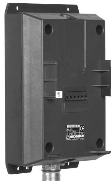
La manivelle radio HR 550 FS est équipée d'un accumulateur. L'accu se recharge dès que la manivelle se trouve dans sa station d'accueil.
