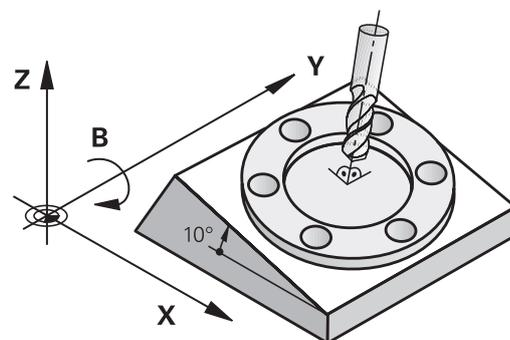
La TNC gère l'inclinaison de plans d'usinage sur des machines équipées de têtes pivotantes ou de tables pivotantes. Cas d'applications classiques : perçages obliques ou contours dans un plan incliné dans l'espace. Le plan d'usinage est alors toujours incliné autour du point zéro actif. L'usinage est programmé normalement dans un plan principal (ex. plan X/Y), il est toutefois exécuté dans le plan incliné par rapport au plan principal.
