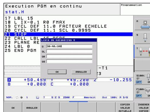
Vous pouvez faire afficher les paramètres Q dans l'affichage d'état supplémentaire ; ceci dans les modes manuel, manivelle électronique, exécution séquentielle ou pas à pas et test de programme.
