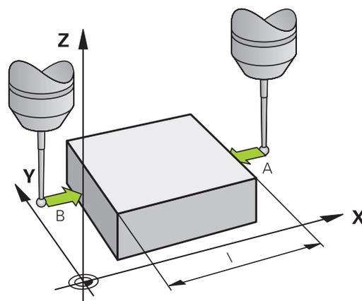
Dans l'affichage Point d'origine est indiquée la distance entre les deux points situés sur l'axe de coordonnées.
