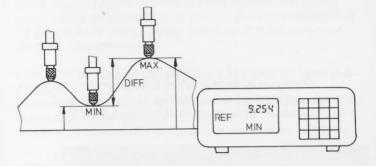
La détermination du Minimum et du Maximum s'effectue toutes les 0,55 ms. Entre ce délai, les Minima/Maxima ne sont pas déterminés. Le mouvement de la pièce doit être tel qu'une modification de la valeur de mesure dans le délai de 0,55 ms est plus petite que la précision souhaitée.
