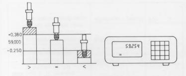
La visualisation de cotes émet l'état de classification sur deux fils pour le traitement externe consécutif. (Voir dans le mode d'emploi "Télé-commande du mode d'utilisation").
