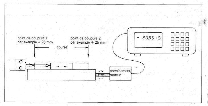
Le palpeur de mesure sert de système de mesure linéaire. Les valeurs des points de coupure 1 et 2 doivent être introduites dans les paramètres P8 et P9 de la visualisation dans la bonne relation. L'entraînement du chariot est coupé dès son positionnement sur un des points de coupure par une électronique de commande appropriée du client.
