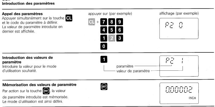
Les valeurs de paramètre introduites sont mémorisées et sauvegardées en cas de coupure de l'alimentation. Après remise sous tension, le compteur fonctionne suivant le mode d'utilisation introduit en dernier.
