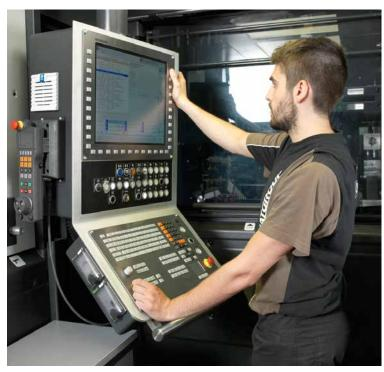
L'opérateur peut passer par les commandes TNC pour intervenir manuellement pendant l'usinage.
