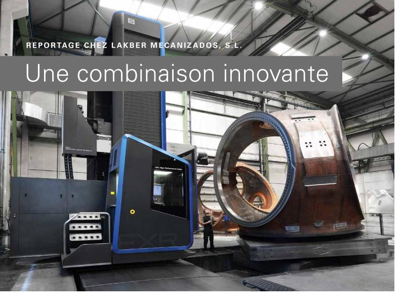
Avec les commandes HEIDENHAIN, les centres de fraisage-alésage à montant mobile de SORALUCE usinent des pièces de très grandes dimensions pour éoliennes, de manière flexible, précise et dans les temps.
