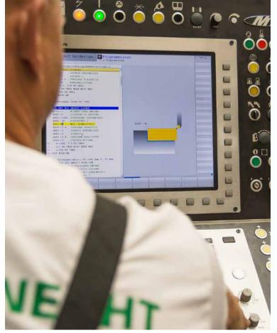
Pour le fraisage comme pour le tournage, les cycles de la TNC 640 permettent de programmer et d'optimiser facilement l'usinage dans l'atelier.
